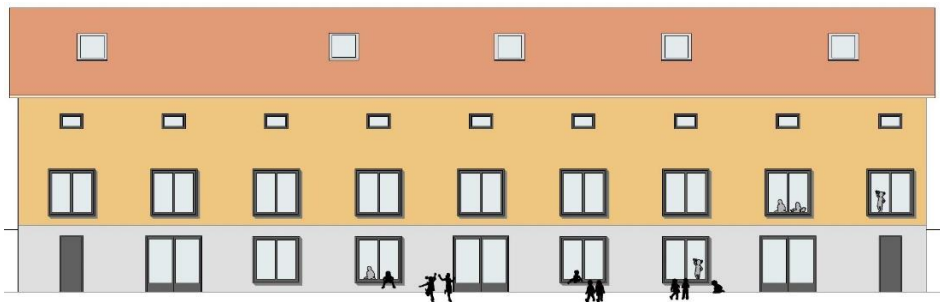
Figur 27. Förslag på utformning av Tygförrådets nordöstra fasad med nya fönster och dörrar efter att lager- och frysrumbyggnaderna rivits. Bild: Tengbom.
