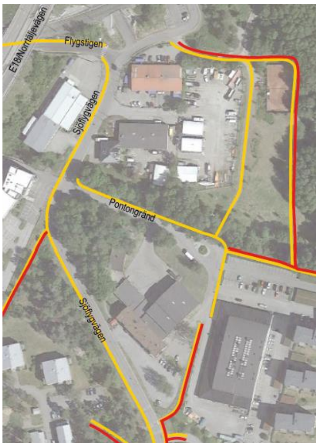
Figur 8. Gångbanor (gula) och cykelvägar (röda) i anslutning till planområdet. Bild: Civit Consult.
